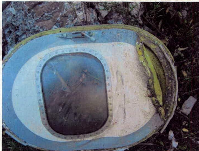
Ventanilla de emergencia
